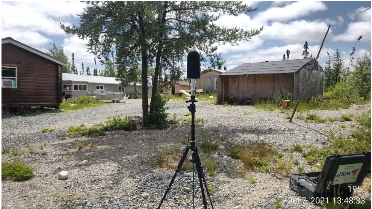
Photo A-1 : Station de mesure installée au point récepteur P1 (camp cri)
