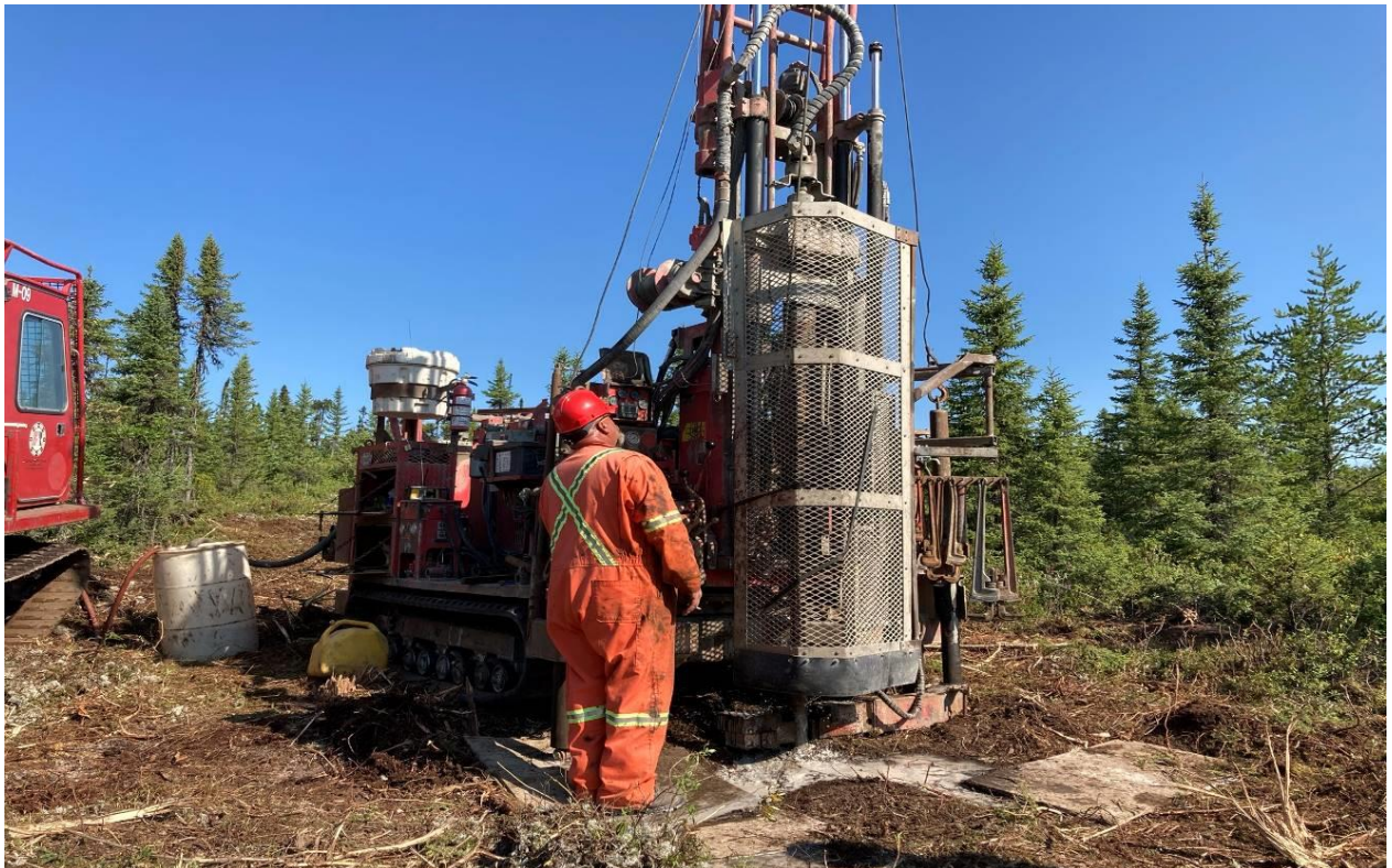
Photo 8 : Réalisation du forage AHS-F02-21
